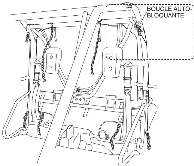
3. Retirer la sangle extérieure inférieure de la boucle autobloquante inférieure. Enrouler la sangle autour du tube inférieur du dispositif de protection des occupants, puis la passer dans l'anneau à l'extrémité de la sangle. Insérer l'extrémité dans la boucle autobloquante. Répéter la procédure sur l'autre côté. Ne pas serrer complètement les sangles à cette étape.
