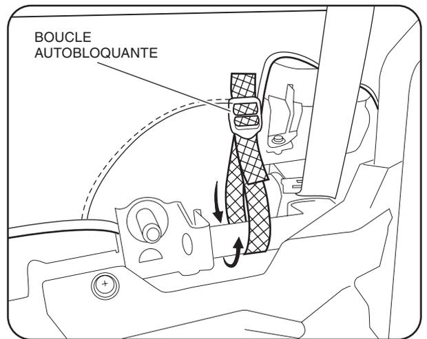
6. Serrer toutes les sangles uniformément. Le haut de la lunette doit être à égalité avec le tube horizontal supérieur du dispositif de protection des occupants. Le bas de la lunette doit être bien tendu.
