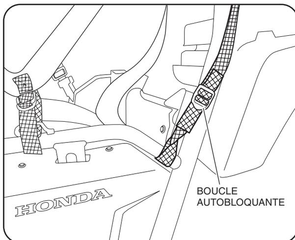
4. Enrouler la sangle centrale supérieure autour du tube horizontal du dispositif de protection des occupants situé derrière les appuie-tête, puis la relever en l'insérant dans la boucle autobloquante. Répéter la procédure sur l'autre côté. Ne pas serrer complètement les sangles à cette étape.
