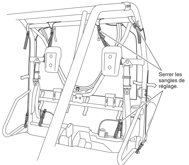
7. Depuis l'intérieur du véhicule, enrouler solidement les sangles autoagrippantes autour des tubes verticaux du dispositif de protection des occupants. Enrouler solidement les sangles autoagrippantes autour du tube horizontal inférieur du dispositif de protection des occupants.
