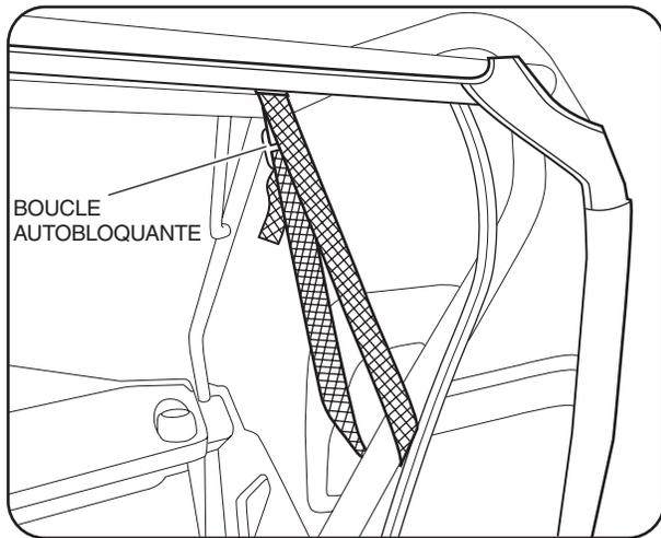
5. Depuis l'intérieur du véhicule, enrouler la sangle intérieure inférieure autour du tube horizontal inférieur du dispositif de protection des occupants, puis la relever en l'insérant dans la boucle autobloquante. Répéter la procédure sur l'autre côté. Ne pas serrer complètement les sangles à cette étape.
